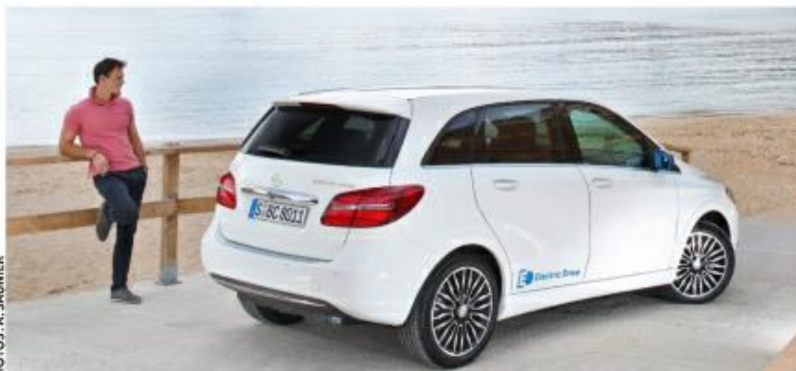
L'agrément de conduite est bon, mais le poids des batteries oblige le Classe B à opter pour des suspensions beaucoup plus fermes.
