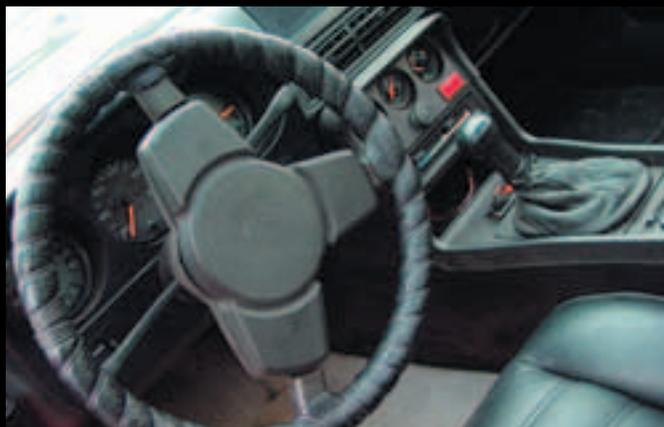
⚡ Салон «924» – это что-то! Просто космическая посадка, и кресла, в которых спина в принципе не устает. Спидометр и тахометр разнесены, справа, на центральной консоли, индикатор давления масла, часы и вольтметр.
